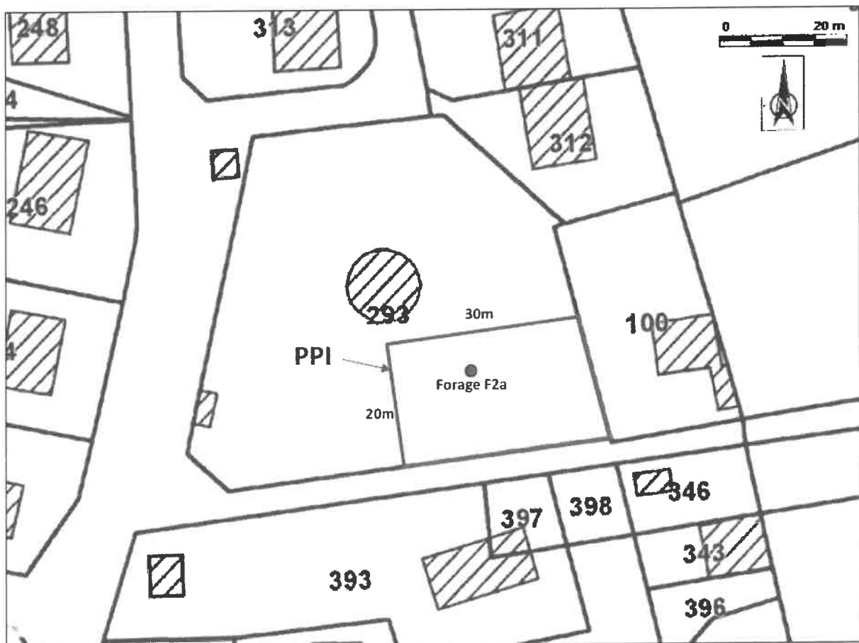
Délimitation du périmètre de protection immédiat du forage « F2a Château d'eau », commune de Châtillon-sur-Indre
